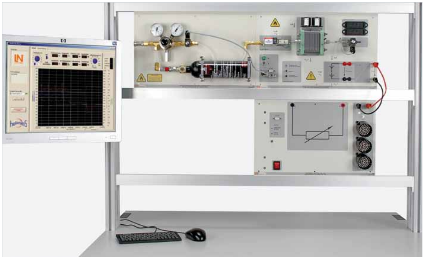
Ejemplo de experimento: "Conjunto de pilas de combustible de 50 VA con cargas", EHY1
